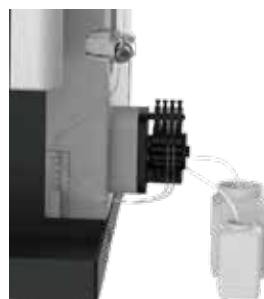
Высокоточный 12-роторный 4-канальный перистальтический насос
